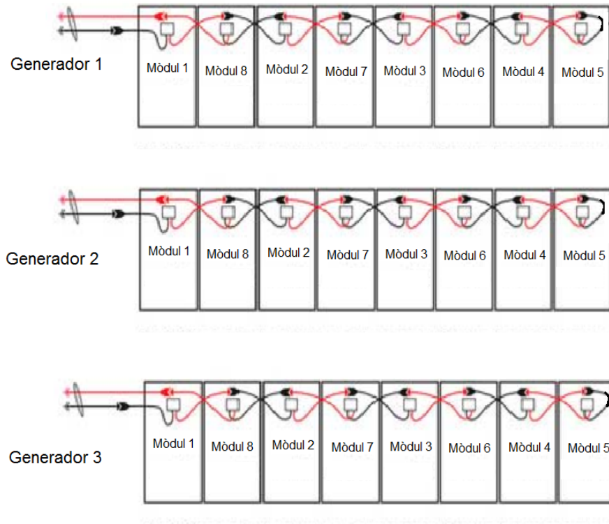
Figura 12. Croquis connexió panells solars instal·lació proposada.
