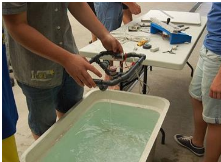
Fig. 2.1 Model de l'R2B2 fet amb tubs de PVC
