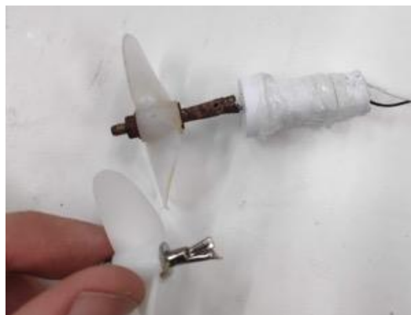
Fig. 10.4 Eix de l'hèlix aplastat sobre l'eix del motor
