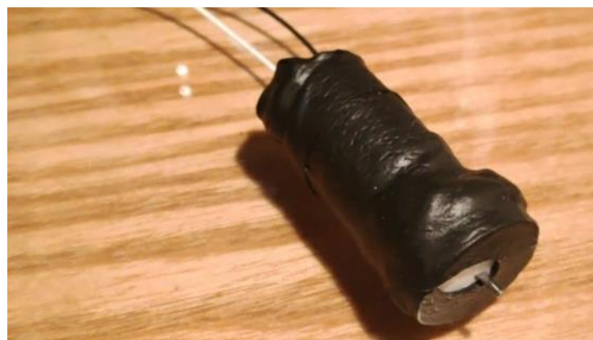
Fig. 5.11 Motor totalment aïllat
