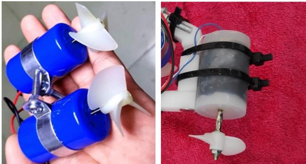
Fig. 2.14 Motors resistents a l'aigua d'Ebay (esq) - Motors encapsulats utilitzats per l'R2B2 (dret)
