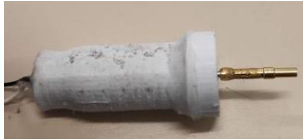
Fig. 10.5 Eix del motor recobert amb un altre eix enganxat amb cola
