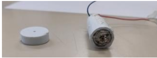
Fig. 5.9 Motor dins l'encapsulament, preparat per posar el tap
