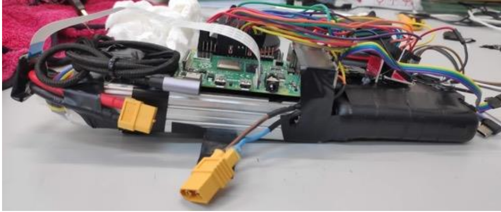
Fig. 2.15 Connexions amb la bateria LiPo
