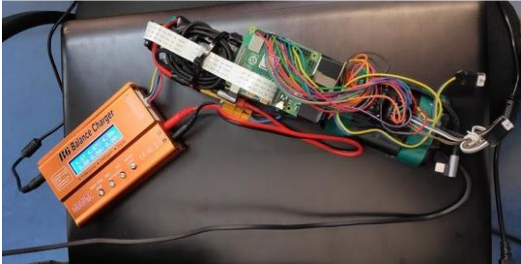
Fig. 7.2 Càrrega simultània de les dues bateries
