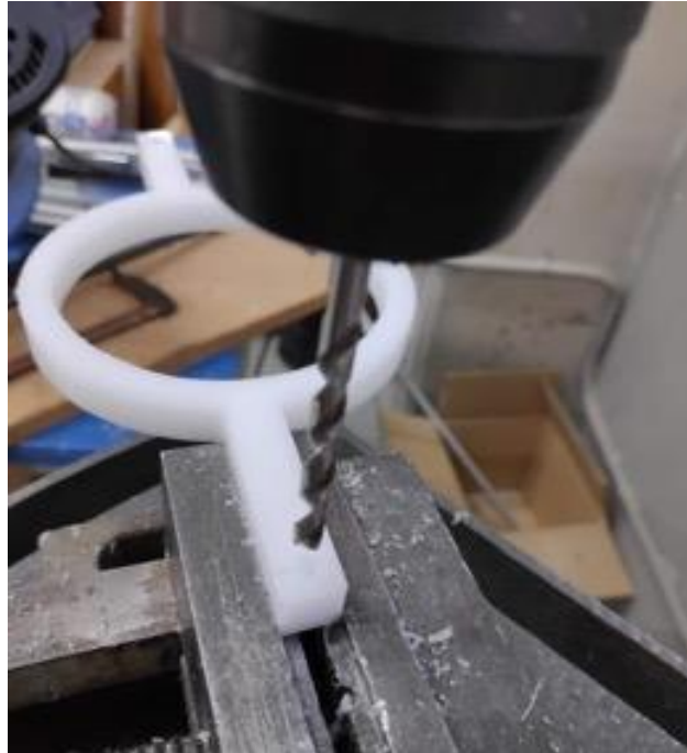
Fig. 5.19 Foradant la peça amb mètric3 per posar-hi l'helicoil
