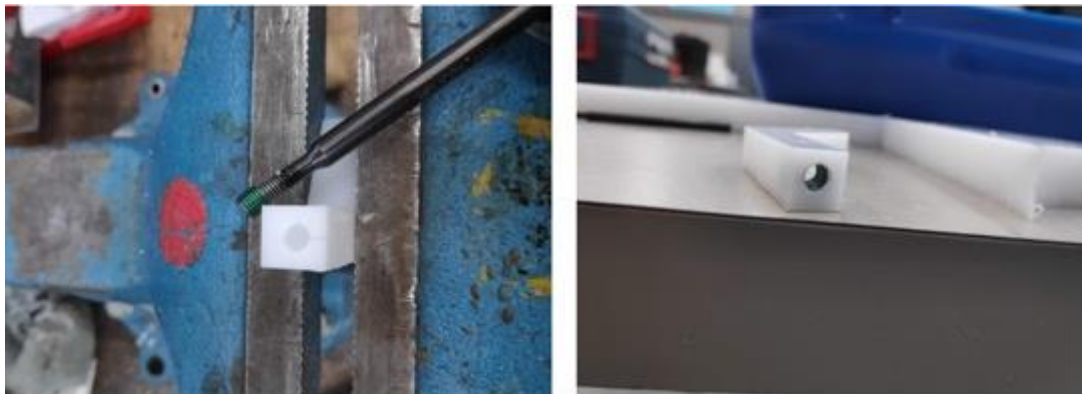
Fig. 5.20 Ús de l'helicoil
