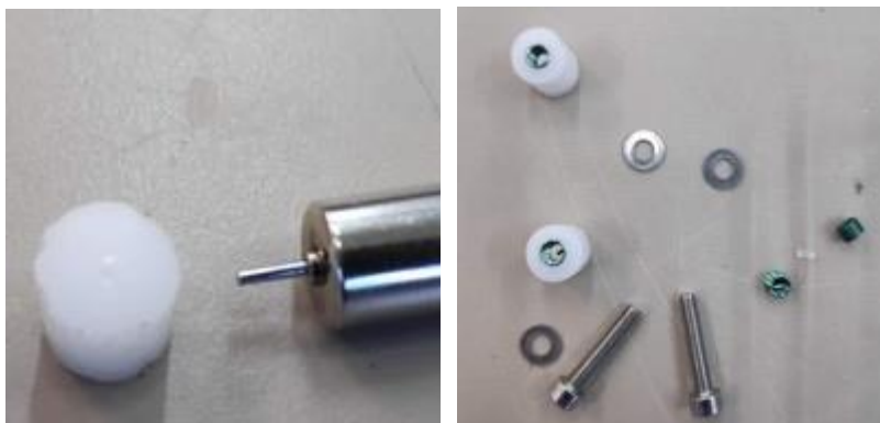
Fig. 5.12 Motor amb l'acoblament per l'eix (esq.) - Acoblament amb l'helicoil instal·lat (dreta)
