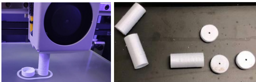
Fig. 5.8 Procés i resultat de l'impressió en 3D dels recipients
