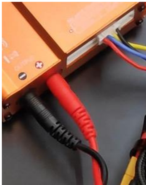
Fig. 7.1 Connexions al balancejador
