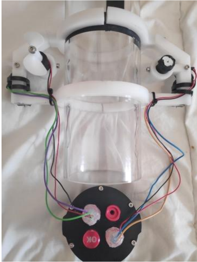
Fig. 5.17 Motors connectats i xassis muntat a l'encapsulament
