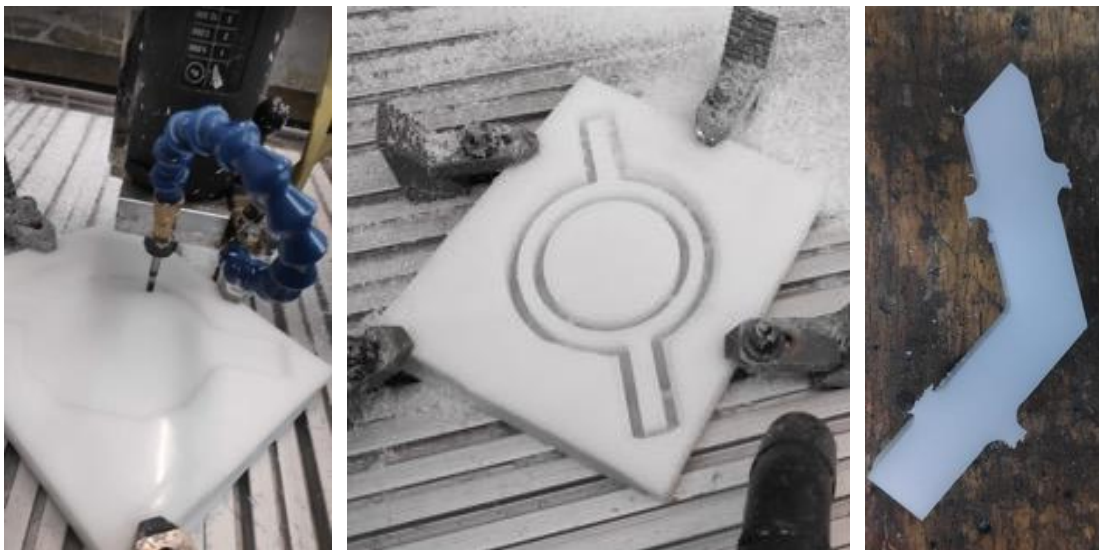
Fig. 5.18 Procés de fresa d'una peça
