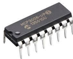
Figura 26: Xip conversor A/D MCP3008
