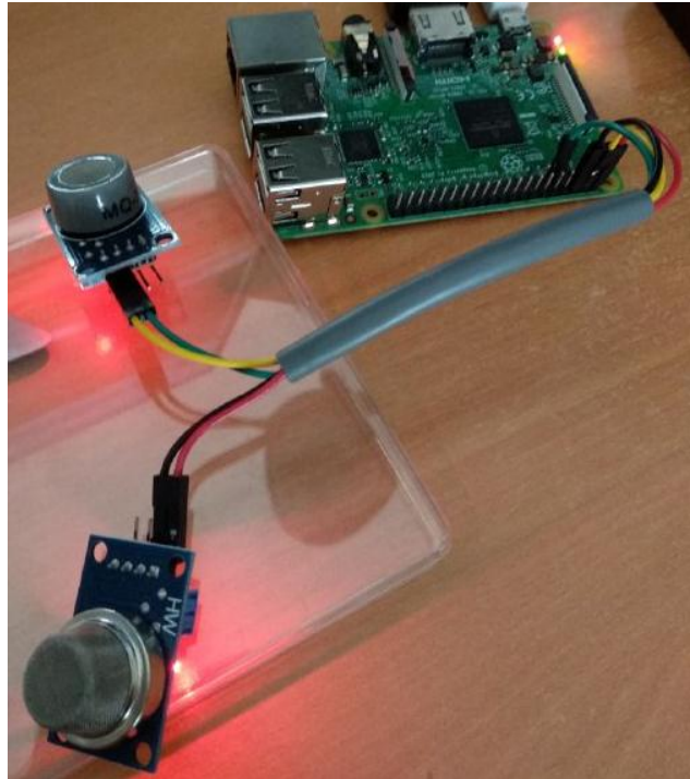
Figura 48: Cremat dels dos sensors durant 24h alimentats amb una Raspberry Pi 3B
