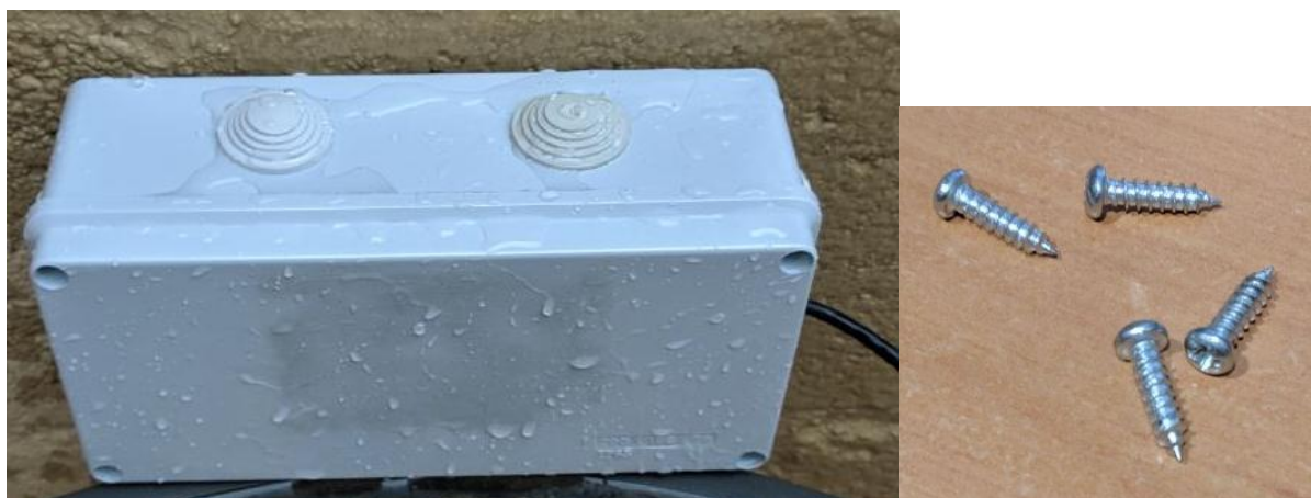
Figura 62: Caixa després de la prova de mullat i caragols utilitzats pel tancament, ja inclosos en la compra de la caixa
