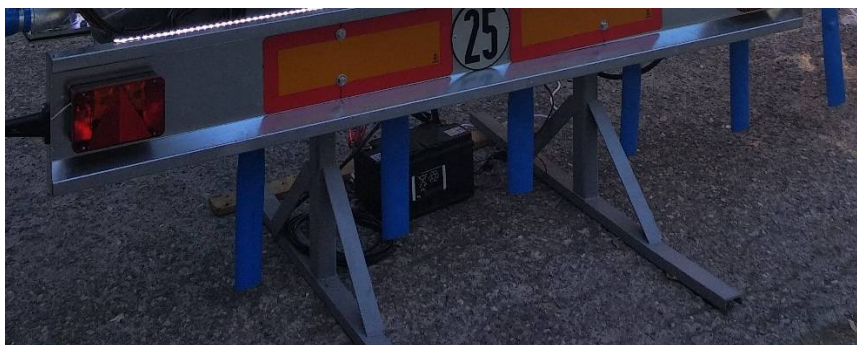
Imatge 19 : Detall de peus d'un aplicador desconnectat de la cisterna. Font : Pròpia (cisterna Plumed ALP 1400, fira de St Miquel de Lleida 2018)
