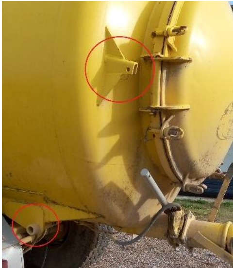
Imatge 10 : Detall dels punts d'ancoratge de la cisterna
