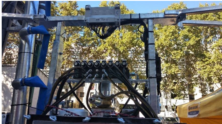
Imatge 18 : Detall de pòrtic amb encaixos i grup d'electrovàlvules.
