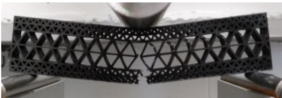
Figura 21: Trencament proveta 6P-25
