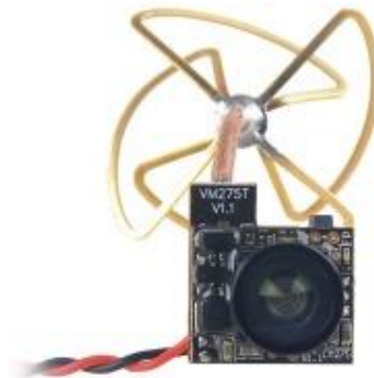
Figura 29. Microcàmera FPV amb emissor de 25 mW
