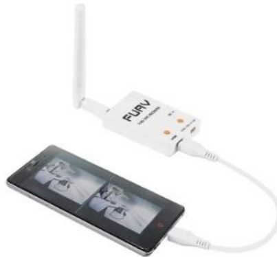
Figura 30. Receptor UVC OTG FPV connectat a un telèfon mòbil
