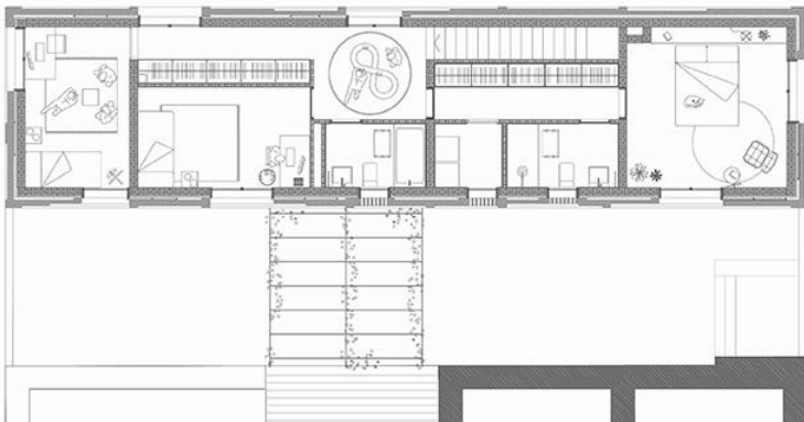
Figura 3- Can Gillem i na Cati mostra un passadís en el qual s'hi ha ubicat els armaris aportant un ús complementari al pas; Ted'A; 2011. Extret de la pàgina oficial: http://www.tedaarquitectes.com/
