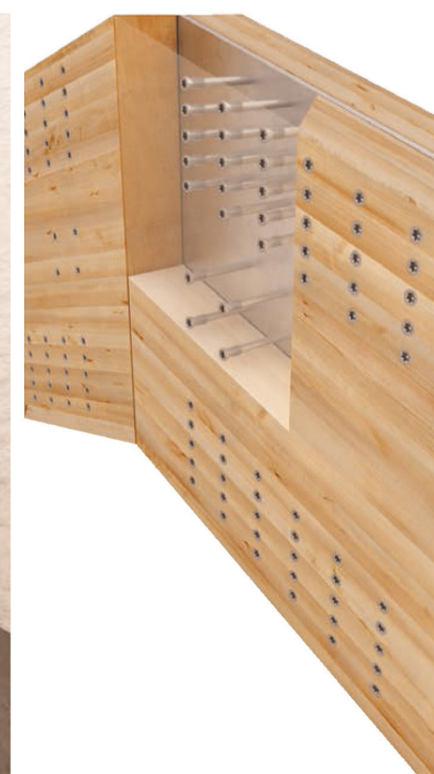
UNIÓ RÍGIDA DE DUES JÀSSERES INCLINADES
