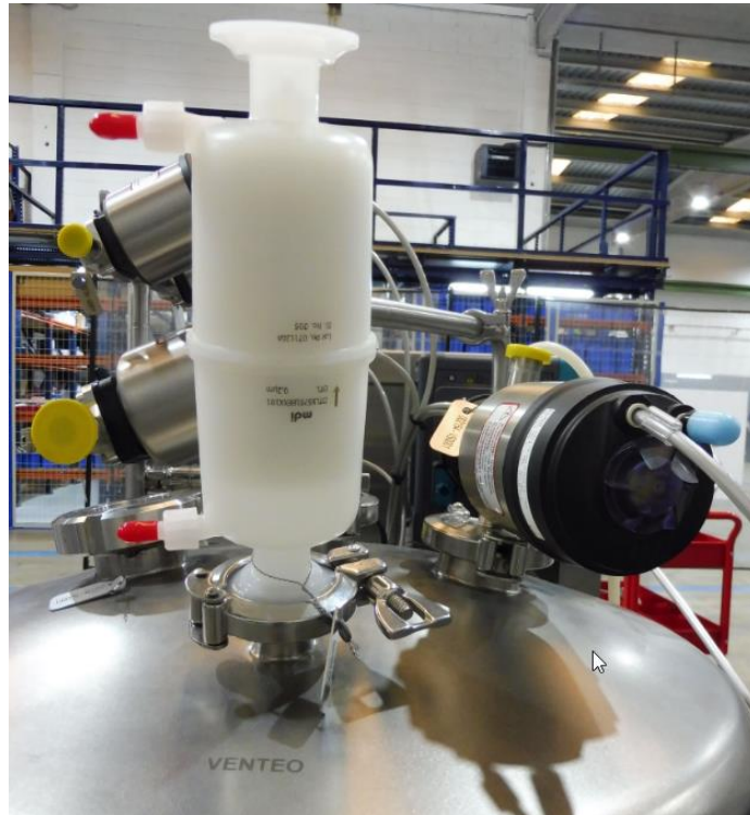
Figura Annex 96: Filtre de venteig del dipòsit pulmó
