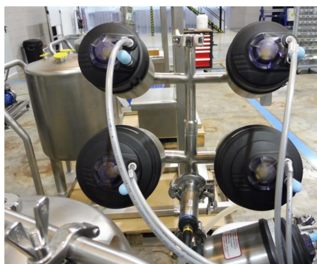
Figura Annex 116: Conjunt de vàlvules Burkert i sensor de pressió Cerabar PMP23
