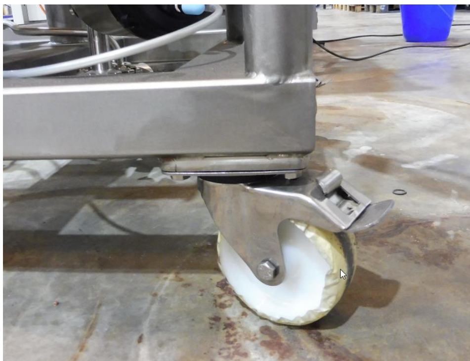
Figura Annex 120: Roda mòbils i soldadura bancada
