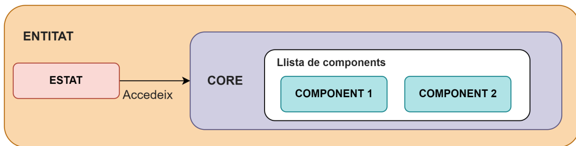
Figura 8.2.2: Estructura de comunicació entre els estats i els Core Components de l'Entitat
