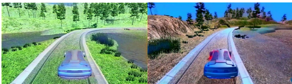
Figura 4 Processat en temps real dins del joc, passant la xarxa neuronal amb dimensió de 512x512 píxels. A) Xarxa entrenada amb 1 cotxe i 1 escenari b) Xarxa entrenada amb diferents cotxes i diferents escenaris.
