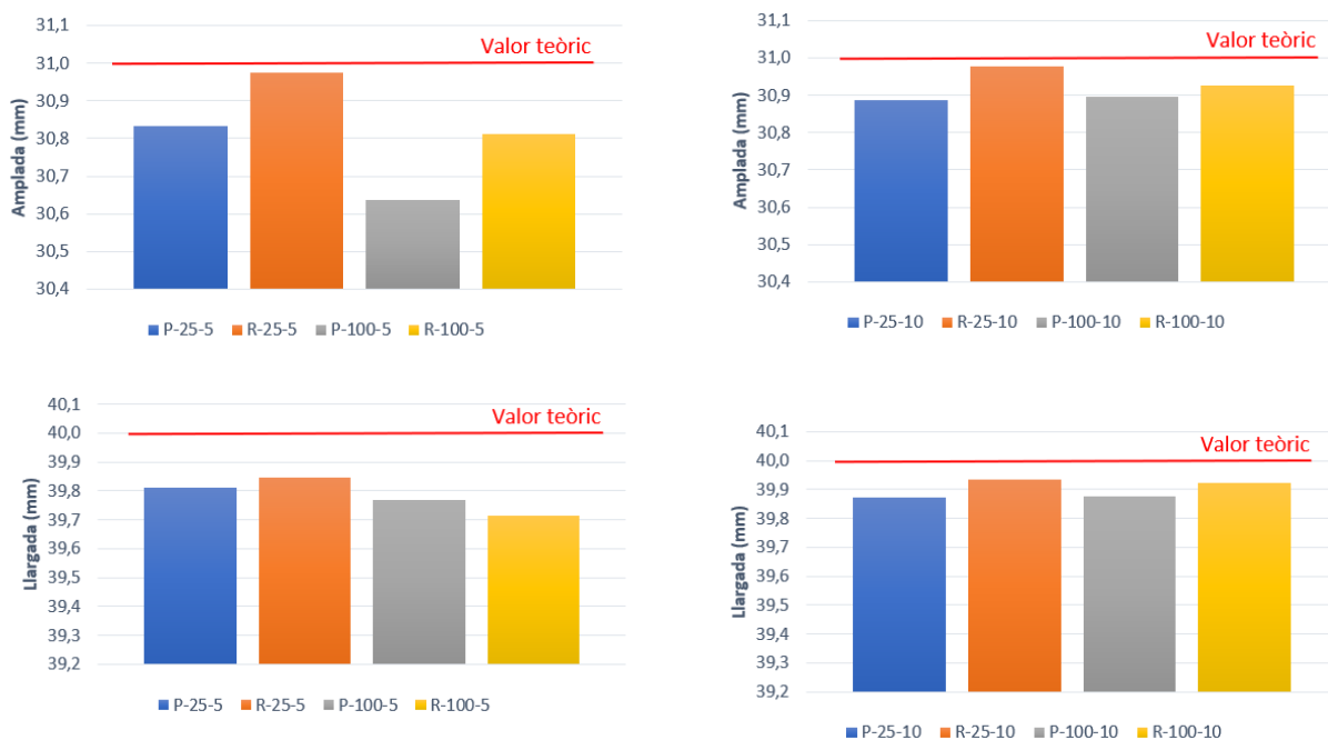
Figura 39. Gràfiques precisió exterior placa fina en amplada i llargada.
