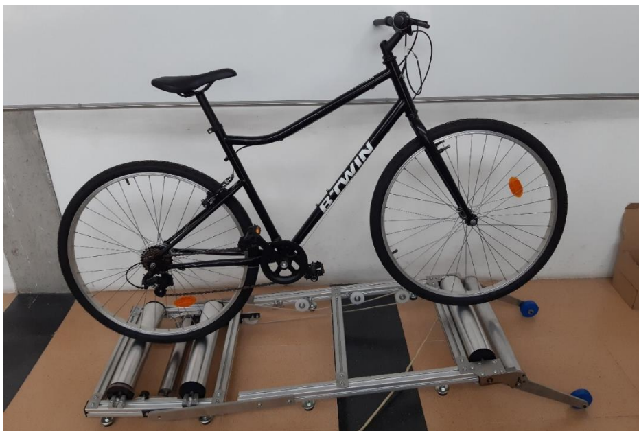
Figura 6: Vista del banc inclinat amb una bicicleta
