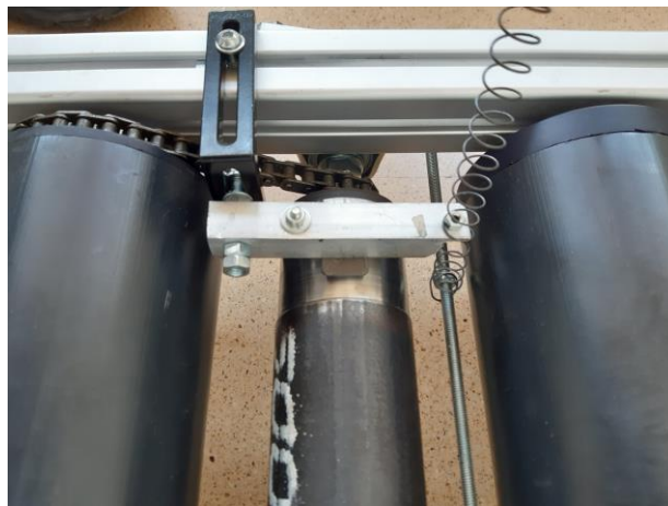
Figura B.1: Vista del fre amb el que es van efectuar les proves
