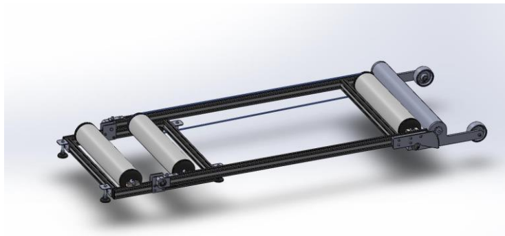
Figura 3: Banc de corrons amb simulació de pujades
