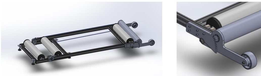
Figura 5 i 6: Vista general i detall del banc de corrns amb simulació de pujades
