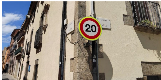
Imatge 37: Senyal vertical de limitació 20km/h en accés a carrer Major de plataforma única. Font: pròpia
