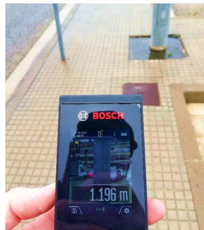
Figura 3: Presa de mesures amb "làser"
