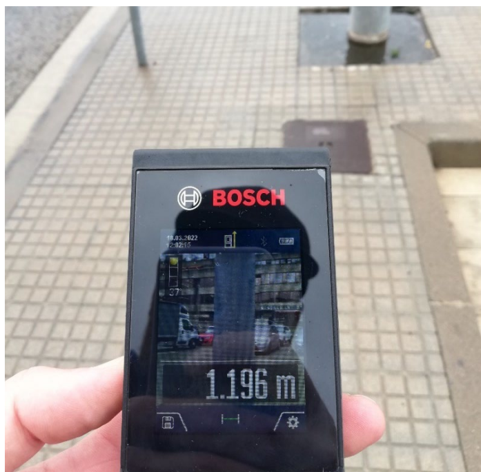
Imatge 8: presa de mides amb mesurador làser de distàncies GLM 120 C. Font: pròpia
