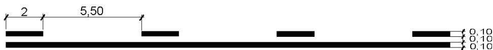
Figura 39: marca M-3.3 per a travesses i vies urbanes, amb cotes en metres. Font: norma 8.2-IC al web mitma.gob.es
