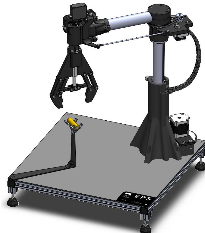
Figura 6: Disseny 3D final del braç robòtic incorporant els re-disseny.
