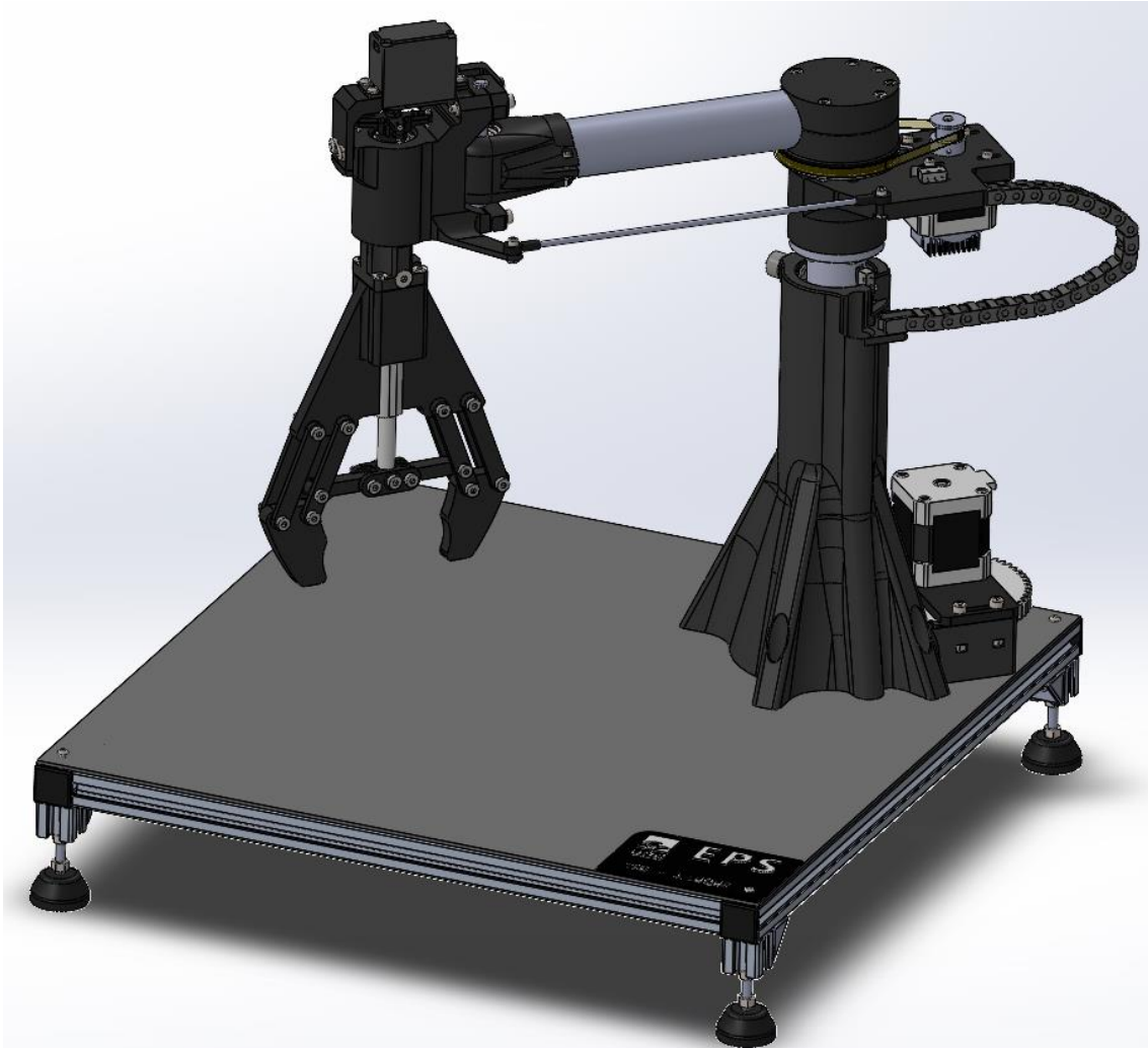
Figura D.2.6: Acoblament completat del braç robòtic.
