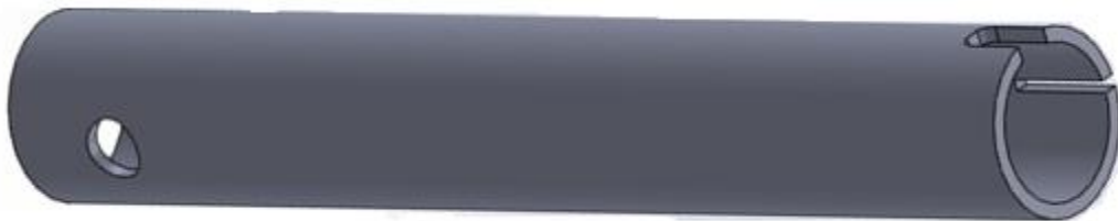
Figura 17: Mecanitzacions en tub 501. Tub unió colze – canell.
