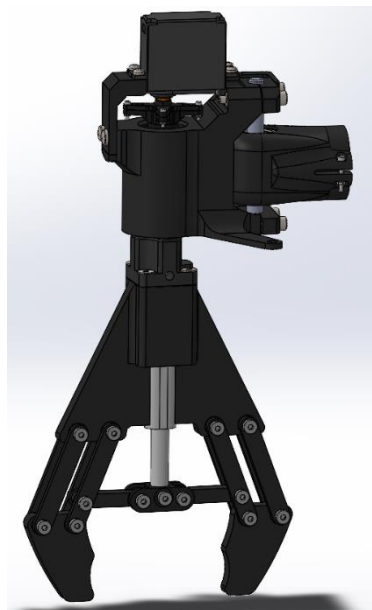
Figura D.2.5: Acoblament dels subconjunts pinça (100) i canell (200).
