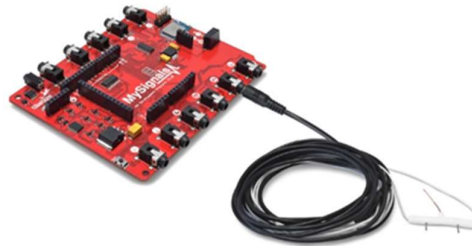
Figura 178. Connexió del sensor de ritme respiratori amb el shield de MySignals
