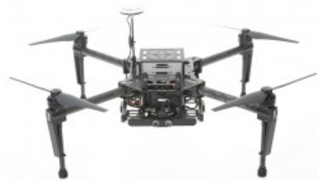
Figura 7. Xassís amb els motors i el GPS
