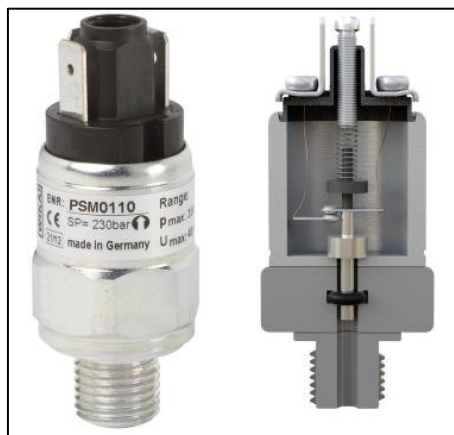
Figura 36. Tall transversal d'un pressòstat
