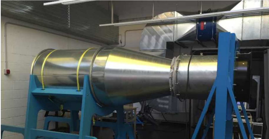
Figura 11. Conjunt ventilador, túnel de vent i malla.
