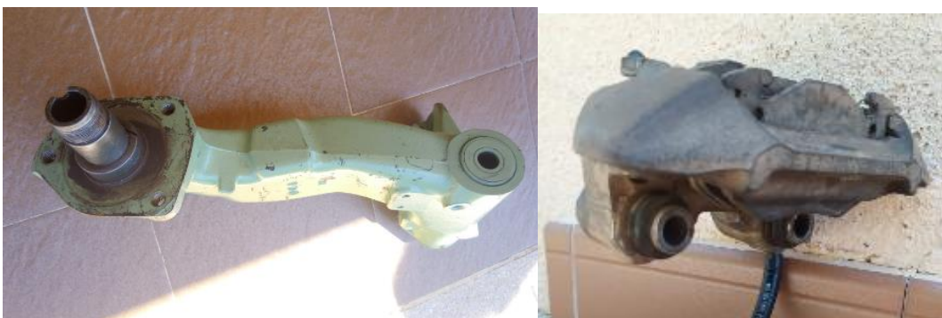
Figura 6 i 7. Braç de suspensió (c15) i pinça de fre (Xsara).
