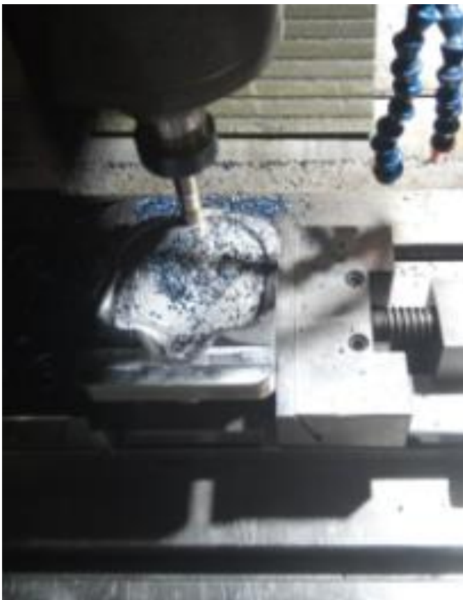
Operació de desbast de la caixa interior.
