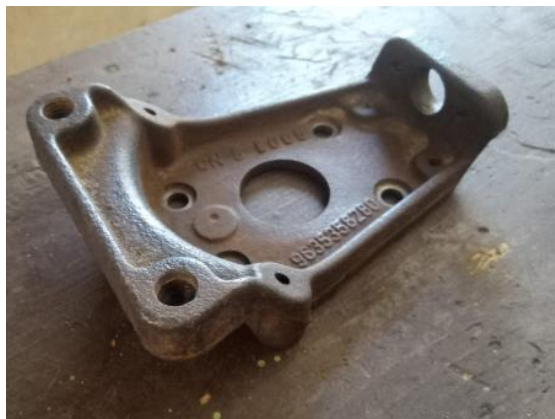
Figura 9. Peça de subjecció de la pinça original (xsara).
