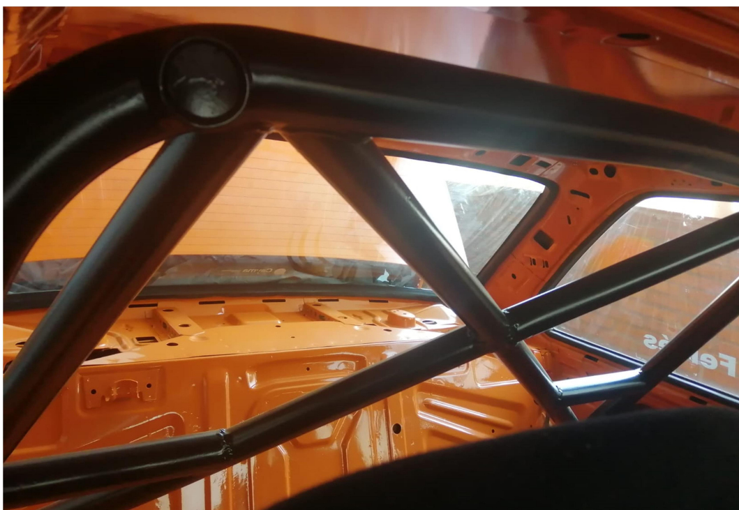
Figura 4.16 Arco de seguridad interior contra vuelco
