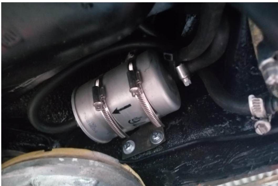
Figura 4.6 Reubicación del filtro de combustible para la instalación de la nueva unidad motora
