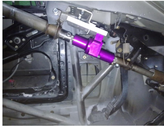
Fig.A.3.5.1 Multiplicador de gir instal·lat en un E30 de competició
