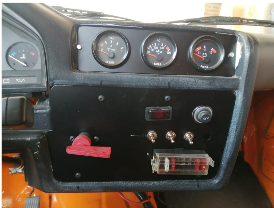
Figura 4.12 Cuadro instrumentos modificado.
