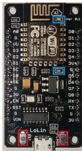
Figura 26. LEDs i polsadors de placa indicats
