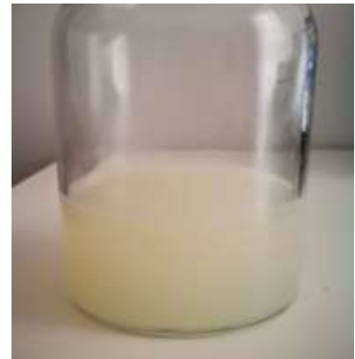
Figura 49: Mostra d'assaig disgregada en aigua passat 24 hores. Font pròpia.
