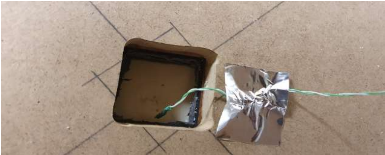
Figura 71: Instal·lació del termoparell a la cara freda. Font pròpia.
