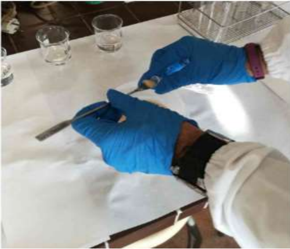
Figura 39: Introducció de la caseïna solidificada i triturada en el tub d'assaig. Foto pròpia.
