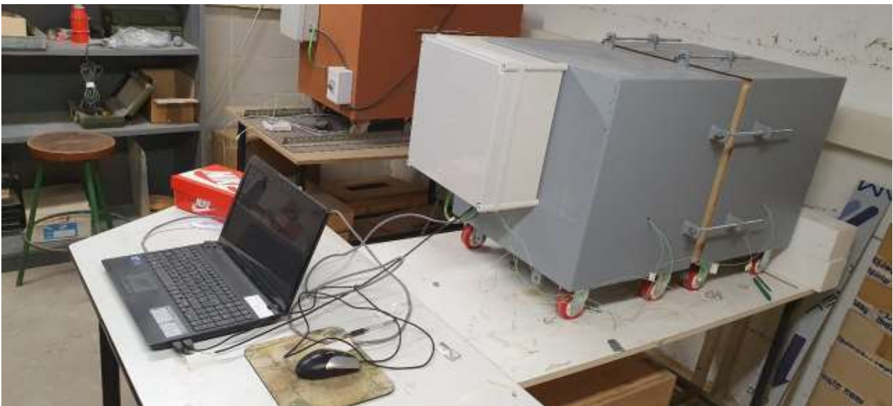
Figura 63: Caixa tèrmica calibrada ,equip complet en execució. Font pròpia.
