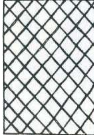
Figura 11: Exemple de mur fet a Opus Reticulatum. Font: https://www.romanoimpero.com/2012/03/cementum-romano.html .
