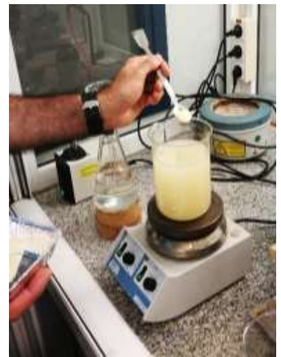
Figura 44: Mescla de la caseïna en pols amb el preparat de fosfat sòdic. Font: Elaboració pròpia.
