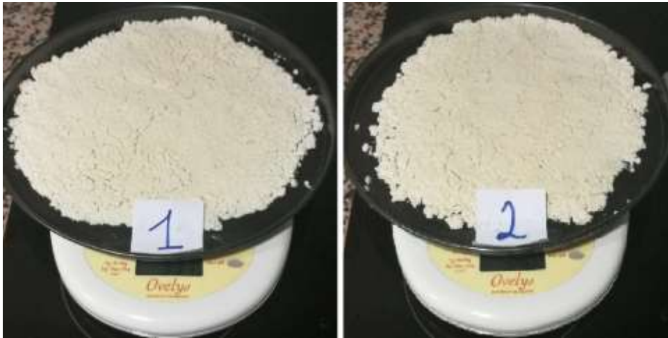
Figura 35: Massa de caseïna estesa preparada per a introduir-la al forn. Foto pròpia,
