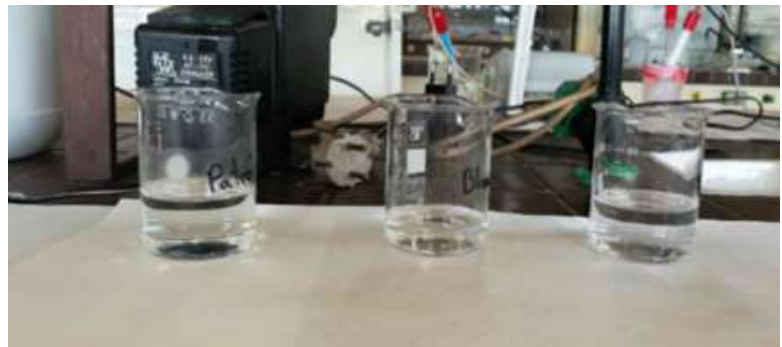
Figura 38: Preparat d'hidròxid de sodi de 40%, 20% i 10% respectivament. Font pròpia.
