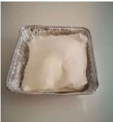
Figura 47: Mostra d'assaig ja solidificada amb el liofilitzador. Font pròpia
