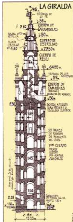
Figura 14: La Giralda té una alçada de 96 metres, murs de pedra calcària de fins a 2,3 m de gruix. Font: https://es.wikipedia.org/wiki/Giralda
