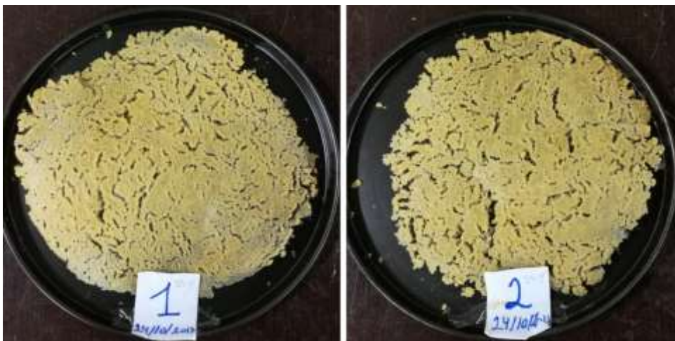
Figura 36: Massa de caseïna assecada al forn. Foto pròpia.
