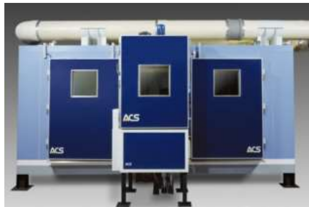
Figura 62: Calorímetre, sistema per mesurar la conductivitat tèrmica en parets i finestres. Font: http://www.mra.pt/industria/actualidade/calorimetro---sistema-para-medicao-da-condutibilidade-termica-em-paredes/
