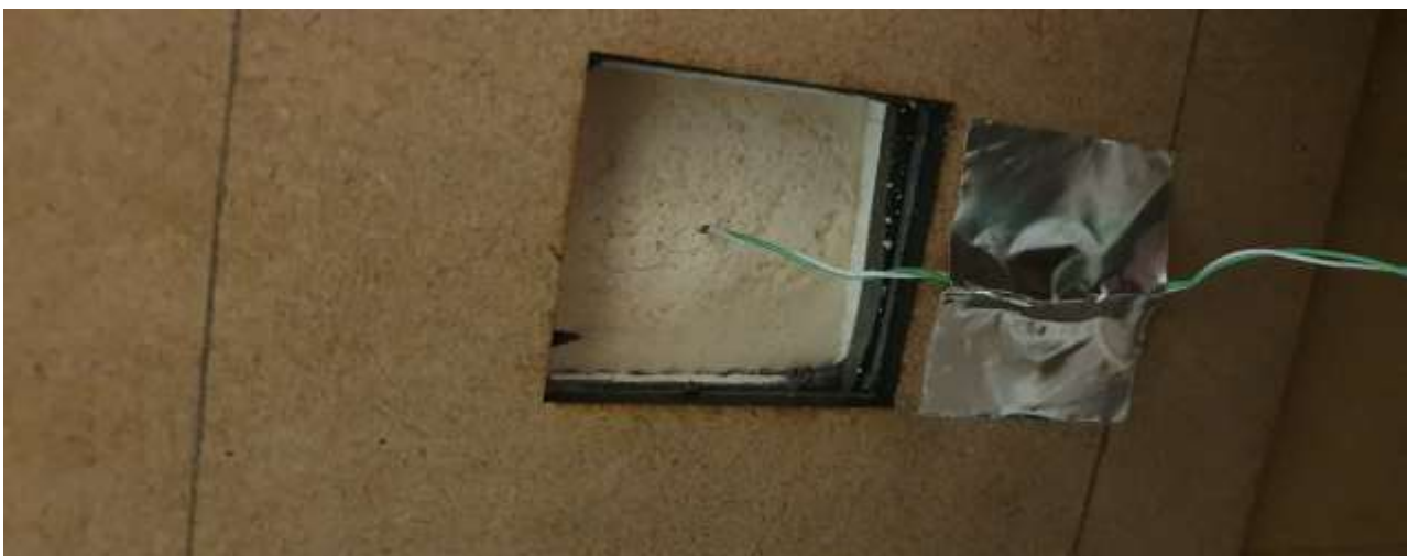
Figura 70: Instal·lació del termoparell a la cara calenta. Font pròpia.
