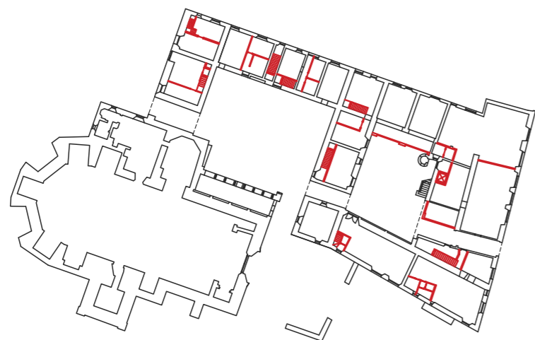
SANEJAMENT eliminació de divisories i volums distorsionants
