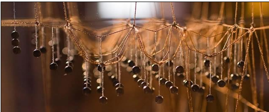
Imatge 13: Formes geomètriques generades a partir de cordills i pesos (polígon funicular).
