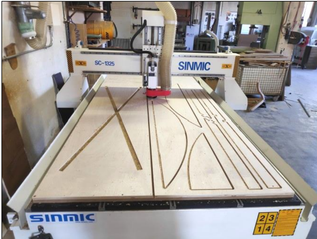
Imatge 16: Tall mecanitzat de les diverses peces que formen l'encofrat.
