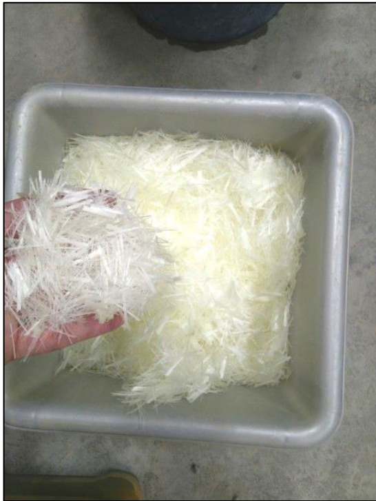
Imatge 25: Fibres de polipropilè (Masterfiber 400)
