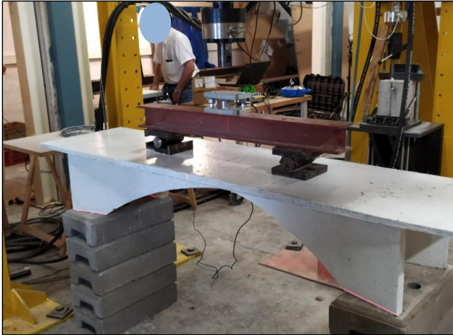
Imatge 39: Prototip amb biga metàl·lica i cèl·lula de càrrega.
