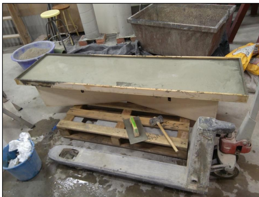
Imatge 28: Prototip formigonat en estat fresc.
