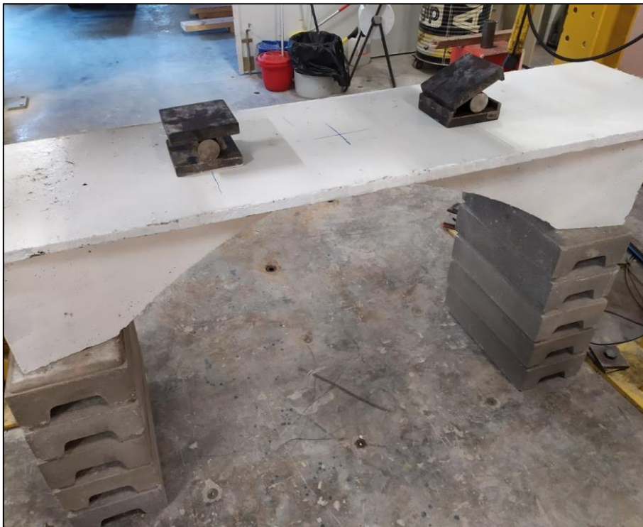
Imatge 38: Prototip amb suports i recolzaments situats.
