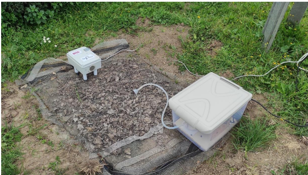
Figura 11: Estació de seguiment ubicada a l'IRTA Mas Badia sobre el llit de fulles infectades amb motejat on s'observa el prototip desenvolupat en el treball (esquerra) i l'aparell de seguiment Ctifl (dreta). Font: pròpia
