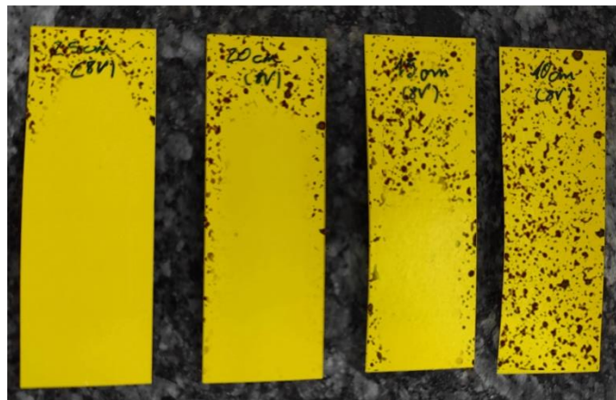
Figura 14: Cobertura observada en la prova de la distància de col·locació del porta-objectes amb la intensitat mitja de l'emissor d'aire. D'esquerra a dreta, 25, 20, 15, 10 cm. Font : Pròpia
