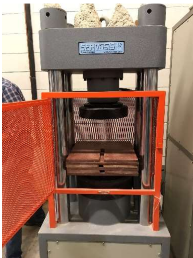
Màquina de compressió
