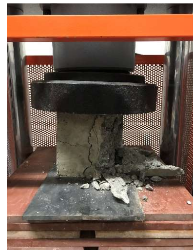
Ruptura de la proveta a compressió
