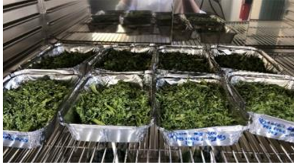
Figura 15: Safates amb substrat de porro triturat dins l'estufa a 60°C (Font pròpia).
