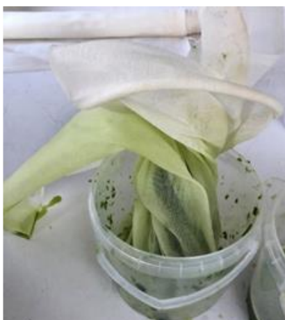
Figura 12: Malla i galleda per l'extracció del líquid d'un substrat de porro per al 78% HR ( Font pròpia ).
