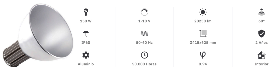
Figura 8.1. Especificacions tècniques campana LED (efectoLED, 2020)
