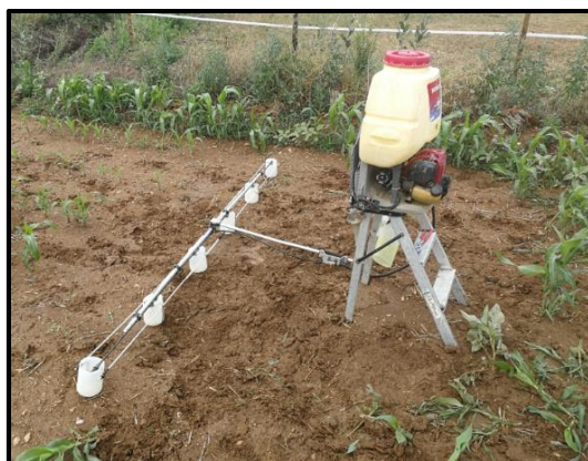
Figura 9: Motxilla polvoritzadora utilitzada a l'assaig.
