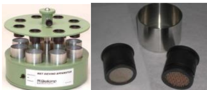
Figura 16. Aparell per portar a terme el test de tamisat humit i detalls dels tamisos utilitzats.
