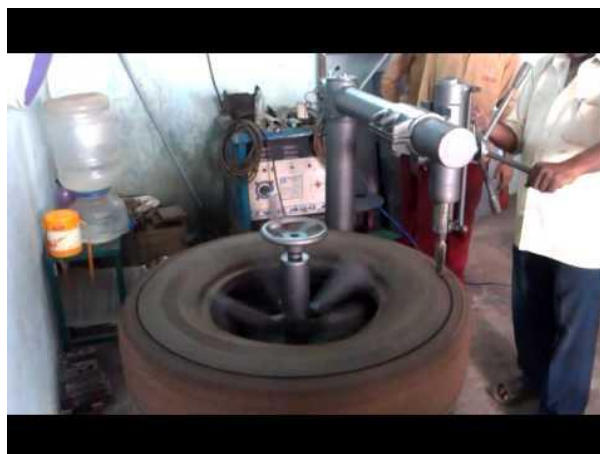
Figura 32. Exemple del moment del tall de la part lateral del pneumàtic. (Font: Youtube, 2014)
