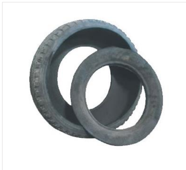
Figura 25. Il·lustració del tall de la part lateral d'un pneumàtic. (Font: ECVV, 2019)
