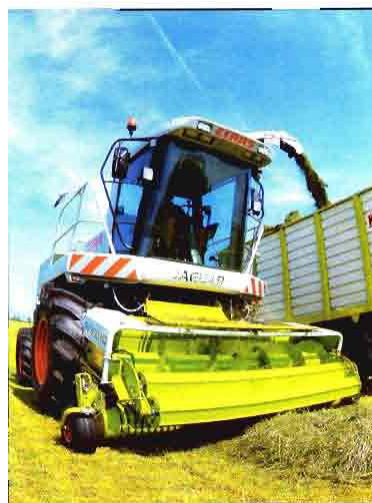
Figura 8. Exemple de condicionadora - picadora amb recollida per aire i recepció per part de remolc. (Font: Researchgate, 2019)
