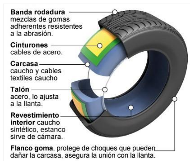
Figura 28. Esquema dels components d'un pneumàtic. (Font: Cultura científica, 2017)
