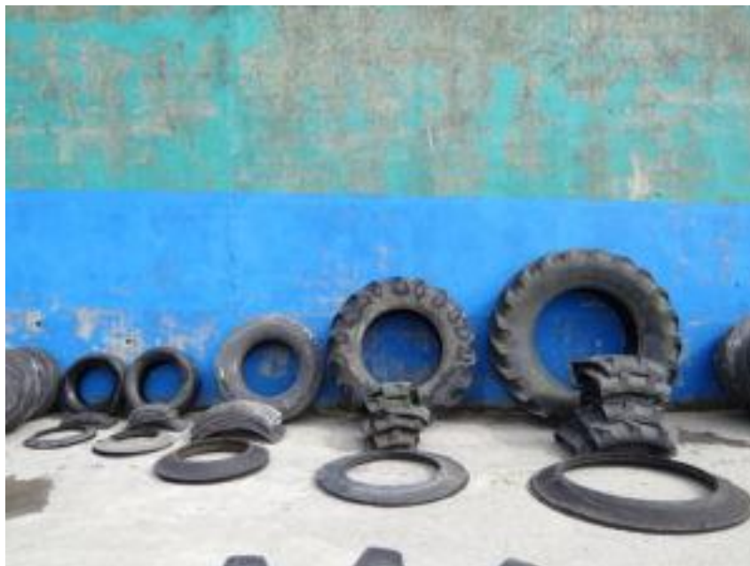
Figura 27. Exemples de rodes tallades de diferents dimensions, conservant la part lateral. (Font: Gradeall, 2019)
