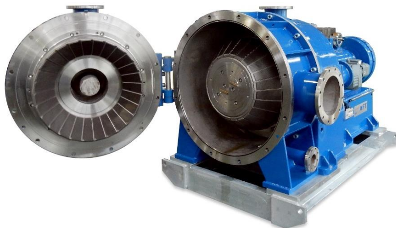
Figura 3.27. Refinador mecànic de doble disc de l'empresa AFT. [137]
