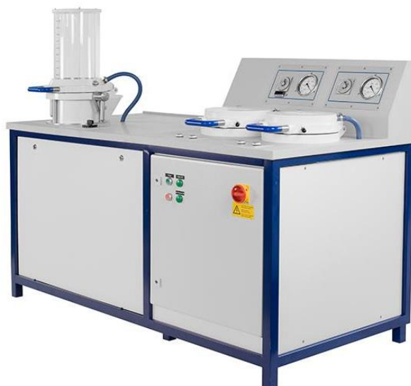
Figura 4.14. Imatge il·lustrativa d'un equip Rapid-Köthen com a possible alternativa per a l'assecatge del substrat. [147]
