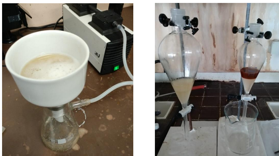
Figura 4.32. Rentat + filtració al buit (esquerra) i posterior decantació (dreta) dels productes de la reacció de polimerització del 9-AF.
