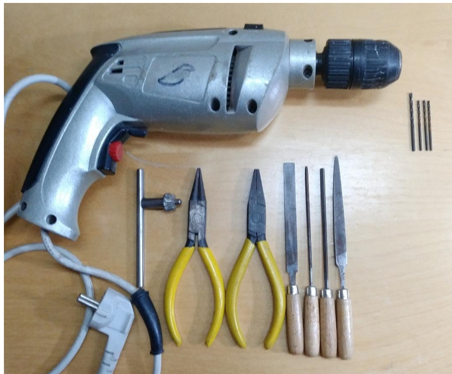
Figura 4.29. Eines per rebaixar, polir, allisar i perforar el material de la carcassa (PLA).
