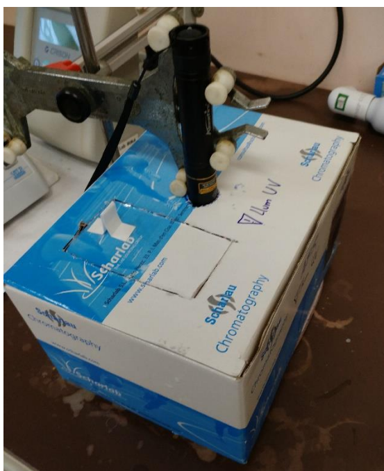
Figura 4.23. Capsa fosca i llanterna LED UV 365nm.
