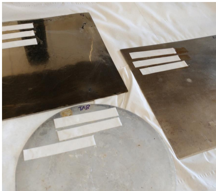
Figura 4.12. Assecatge de les tires a temperatura ambient recobertes amb CNFs sobre plaques metàl·liques.
