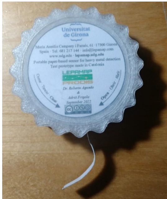
Figura 4.30. Assemblatge de les diferents parts, en aquest cas del format mono-sensor.
