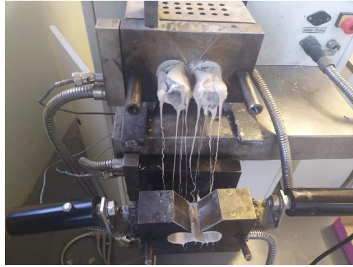
Figura 4-5. Descàrrega del material compost de l'equip Brabender.
