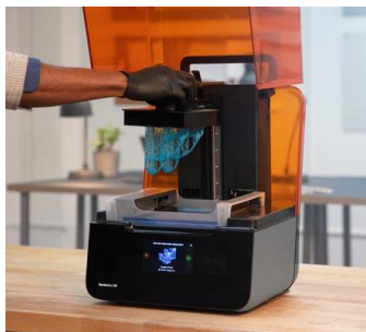
Figura 1-17. Impressió 3D mitjançant SLA.
