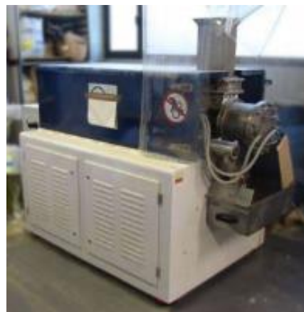
Figura 4-2. Mesclador cinètic d'alta intensitat Gelimat.
