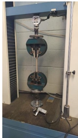
Figura 4-14. Equip muntat per assajar a tracció.
