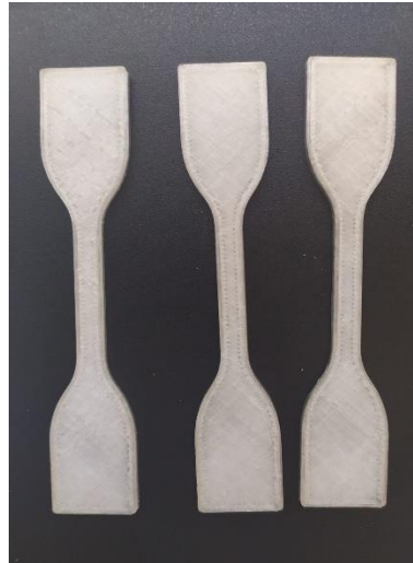
Figura 7-2. Provetes impreses amb PLA Corbion amb impressora Tumaker amb direcció d'impressió 45°.
