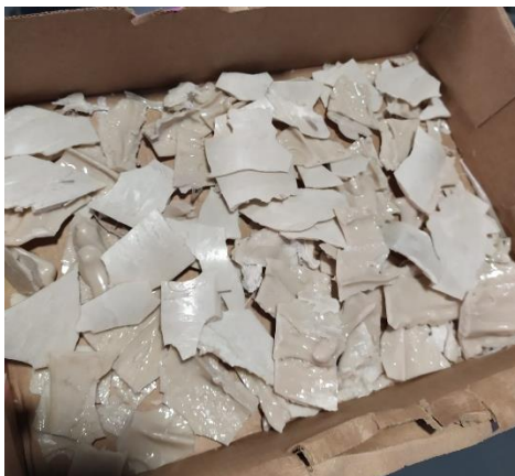
Figura 4-6. Material compòsit després de sortir de la Gelimat.
