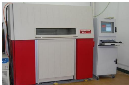
Figura 1-18. Impressió 3D mitjançant SLS.
