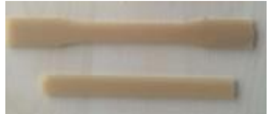
Figura 4-9. Provetes per a assaig de tracció i flexió obtingudes per injecció.
