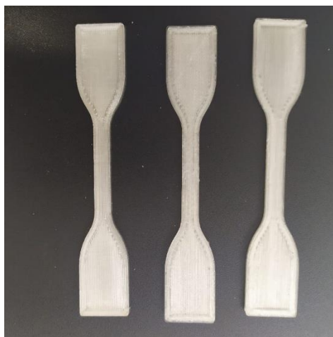
Figura 7-1. Provetes impreses de PLA 4043D amb impressora Tumaker.
