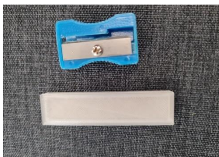
Figura 7-4. Prova de PLA Total-Corbion, impresa amb Ultimaker S3, en comparació amb una maquineta.
