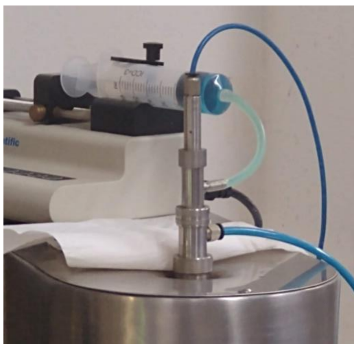
Figura 16: Injecció de la solució de nitrats.
