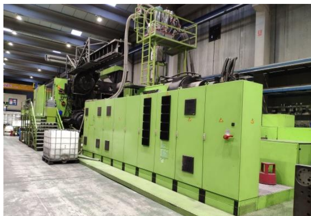
Figura 1: Injectora Engel amb força de tanca de 4000 Tm
