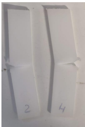
Figura 52: Provetes assajades pel mètode Izod que no trenquen completament
