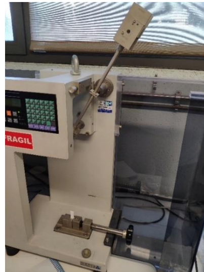
Figura 46: Equip per assajos d'impacte segons el mètode Izod
