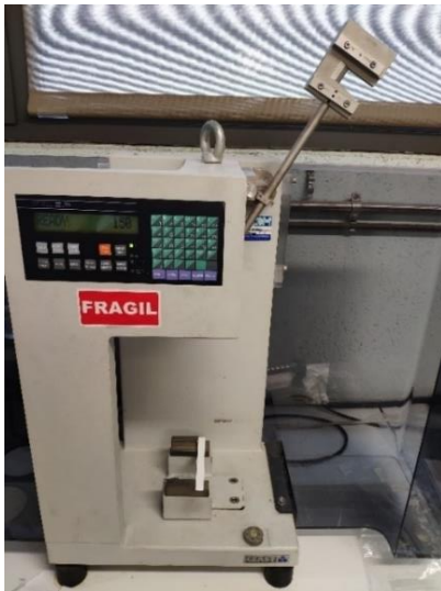
Figura 45: Equip per assajos d'impacte segons el mètode Charpy
