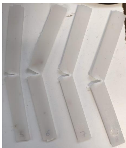
Figura 53: Provetes assajades pel mètode Charpy amb entalla que no trenquen completament
