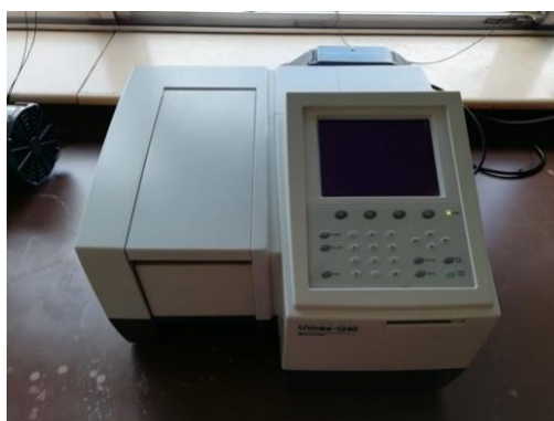
Figura 29. Espectrofotòmetre UV-mini-1240 [Shimadzu].
