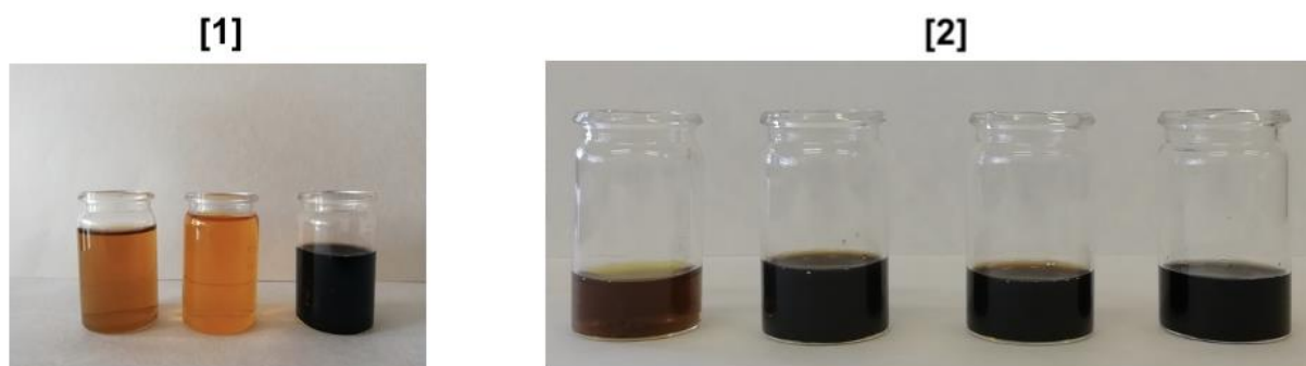
Figura 51. [1] Exemple del canvi de color: extracte rooibos, extracte de \text{FeCl}_3 i solució de ferro zero (d'esquerra a dreta). [2] Síntesis filtrades usant: rapa, cafè, rooibos i Àcid tànnic+Citrat de sodi (d'esquerra a dreta).
