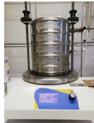
Figura 21. Tamisadora electromagnètica i digital. Dimensions: 445x335x200 m. Voltatge: 230 v-50 Hz / 110 v-60 Hz.
