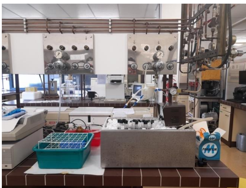
Figura 48. Muntatge per les síntesis de nZVI.
