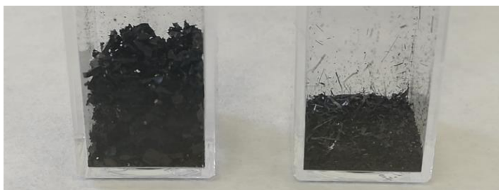
Figura 52. Precipitats de la síntesi utilitzant, a l'esquerra els extractes vegetals i a la dreta l'extracte rooibos.
