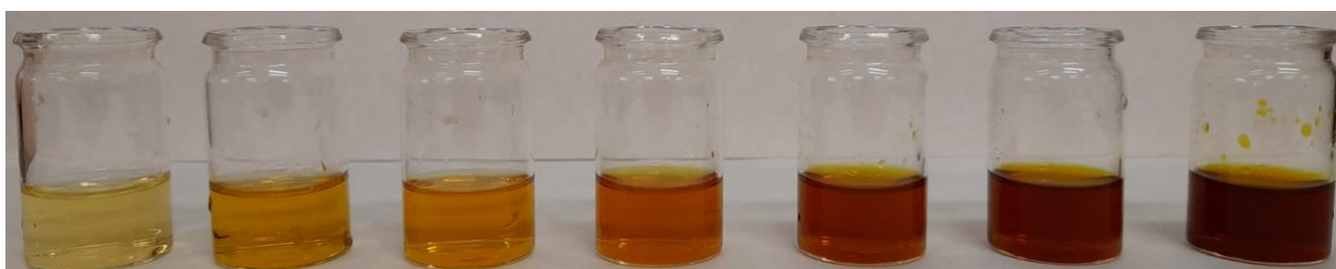
Figura 56. Solucions de \text{FeCl}_3 de concentracions d'esquerra a dreta de 0,01M, 0,05M, 0,1M, 0,25M, 0,5M, 0,75M i 1M.
