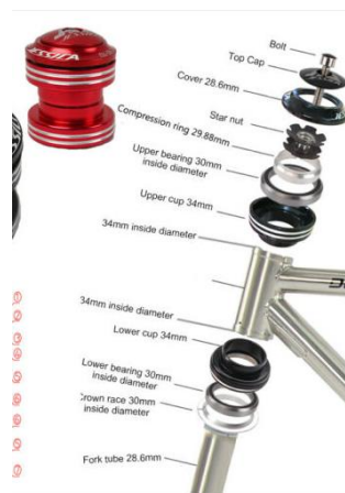
Figura 17: Explosionat de la direcció JESSICA de 34 mm B07ZFJCH91 (www.ebay.es)
