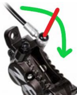
Figura 29: Detall de la pinça de fre amb sistema banjo.
