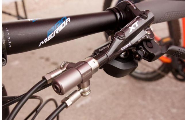
Figura 30: T amb sistema anti-bloqueig muntada a una bicicleta convencional. ( www.singletracks.com )
