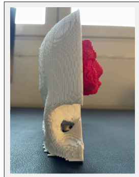
Il·lustració 5. Visió frontal del model del tumor + el model del crani (tall sagital).
