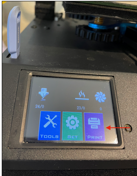
Il·lustració 113. Exemple de les diferents opcions del panell principal de la impressora.
