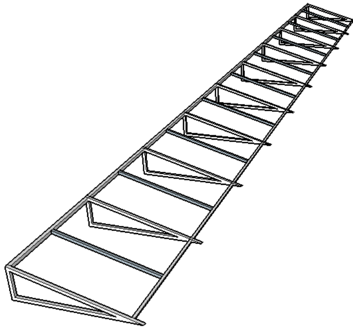
Figura 19: Disseny de l'estructura metàl·lica pels panells fotovoltaics
