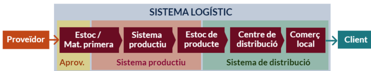
Figura 8. Esquema del sistema logístic i els subsistemes d'aprovisionament, sistema productiu i sistema de distribució del producte.
