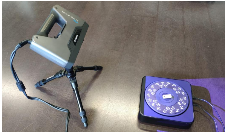
Figura 4.3 Escàner Einscan Pro 2X en funcionament fix (Font pròpia)
