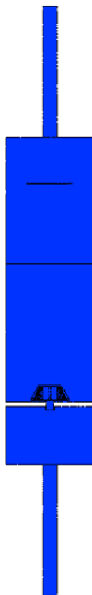
Figura 11: Model del filtre simulat amb conductes d'entrada i sortida de 300mm
