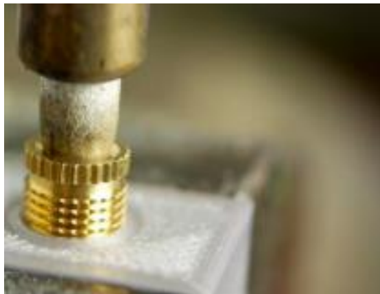
Figura 67: Procés d'introducció del cos roscat (Font: [3W.3])
