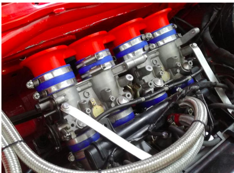
Figura 56: Trompetes instal·lades al vehicle
