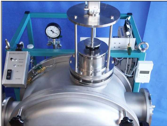
Figura 10.1- 1. Sistema de control de posició autmàtic de l'equip "Melt Spinner SC" de la marca Edmund Bühler GmbH, equip usat pel Grup de Recerca en Materials i Termodinàmica. Edmund Bühler GmbH, Description BÜHLER Melt Spinning Apparatus (SC-Version), Hechingen. 2008.
