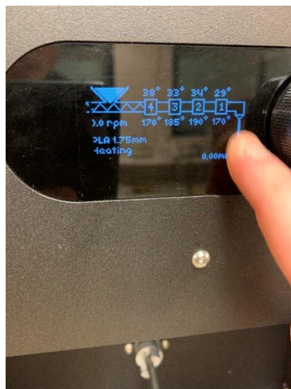
Figura 21 Punts de temperatura en la extrusora de filament. (Font: Elaboració pròpia).
