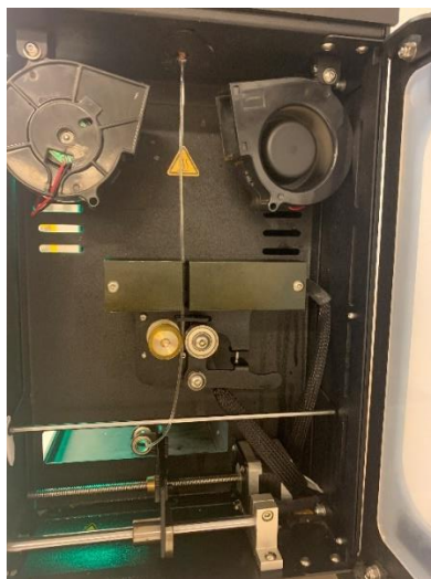
Figura 22 Procés de l'extrusora de filament. (Font: Elaboració pròpia).
