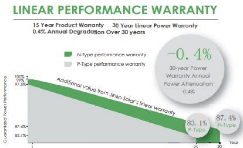
Figura 36. Degradació d'uns panells marca Jinko. Font: [35].
