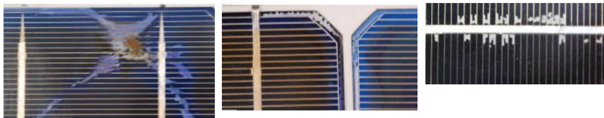
Figura 37. Imatges de diferents problemes per degradació dels panells. Font: [10].
